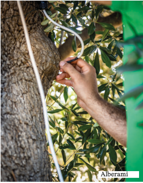
Installazione dispositivo "sap flow" di Plantvoice
