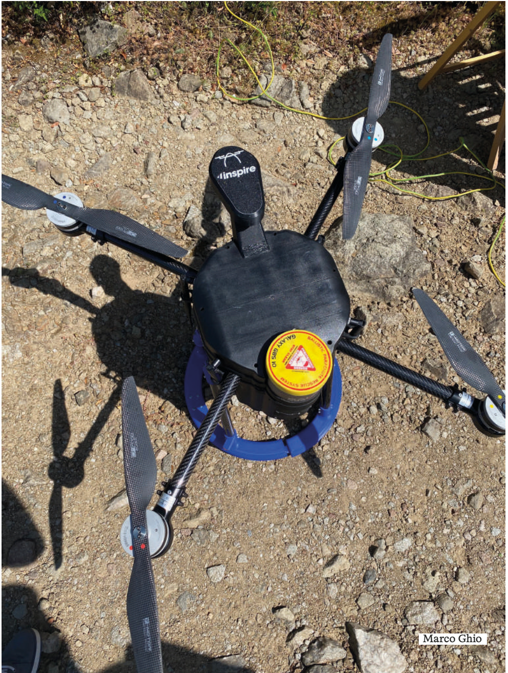
Drone MARS con Telecamera IperSpettrale
