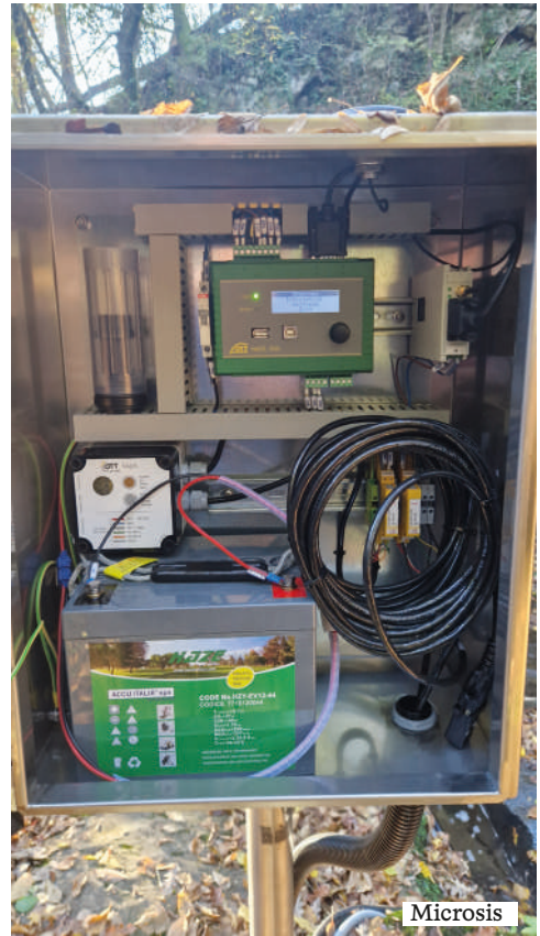
Una stazione di misura con sonde multisensore
