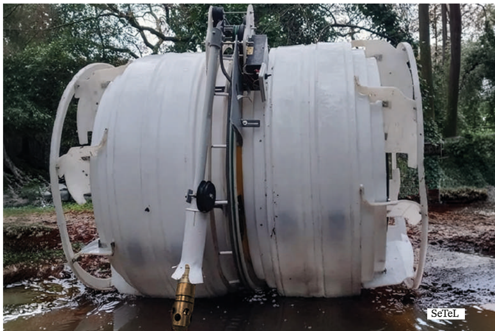
Rover equipaggiato per il monitoraggio della qualità dell'acqua
