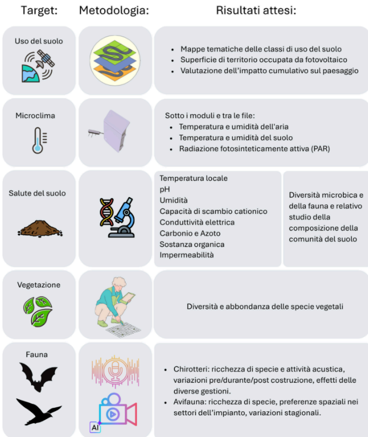
Figura 17 - Schema metodologico e principali risultati attesi del progetto pilota di Montalto di Castro, articolato su diversi target di monitoraggio (uso del suolo, microclima, salute del suolo, vegetazione e fauna) per valutare gli effetti degli impianti fotovoltaici su suolo come NbS
